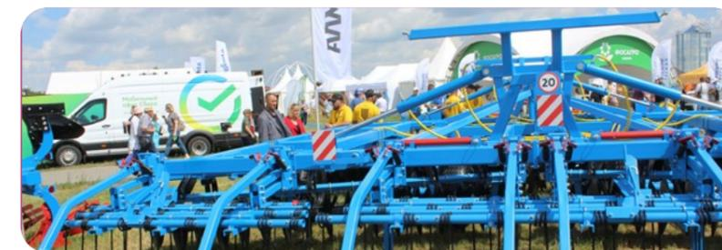
**Pulsar БМ-7** перемешивает верхний слой почвы, подрезая сорняки, стерню и создавая мульчирующий слой – необходимое условие технологии минимальной обработки почвы. Производительность мульчировщика – от 5,4 до 10,3 гектара в час, в зависимости от скорости и агрофона. Ширина захвата – 7,1 метра, масса – 5 тонн 160 кг.
