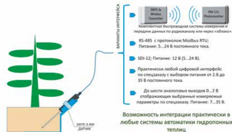
Рис. 3. Варианты интерфейсов для датчика SMTE-3-RW
