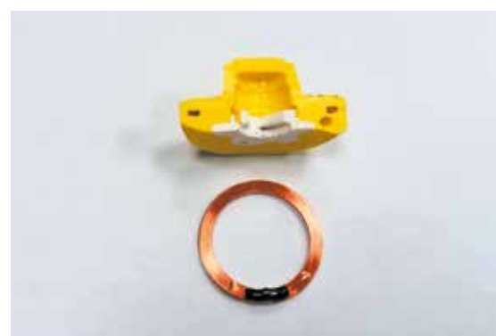
LF-метка (антенна+чип) и ее расположение в бирке
