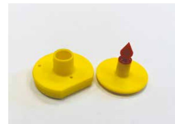
Пассивная UHF-бирка с дальностью считывания 2–3 м
