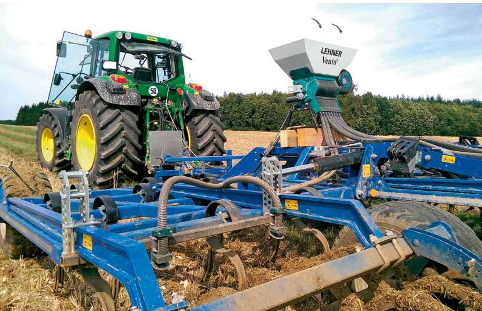
Фото 1. Навесная сеялка пневматического типа, установленная на культиваторе
