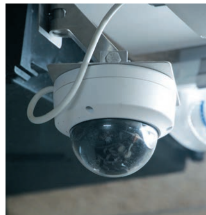
Новая система ProGrow позволяет постоянно отслеживать вес свиней на дорастивании и откорме с помощью камер, установленных над загонами с животными
