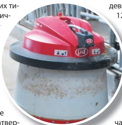
девший навоз Discovery 120 Collector разжижает водой, после чего с помощью вакуумного насоса масса перекачивается в сборный резервуар. Робот имеет распылители воды в передней и задней частях. Спррыкивание
