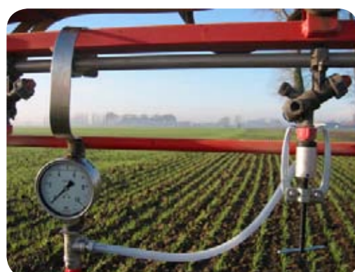
Фото 3. Контрольный манометр, устанавливаемый на распылитель
