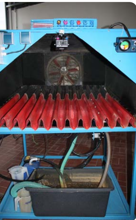
Дождевальная установка, имитирующая работу опрыскивателя при ветре
