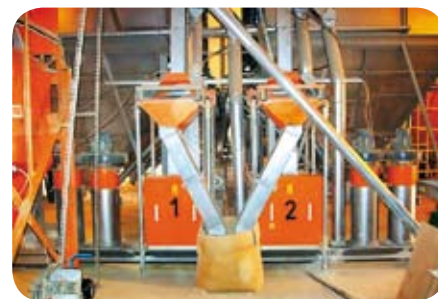
Фото 4. Смесительная установка с двумя дробилками молоткового типа на свинокомплексе «Сувар-2» в Чувашии
