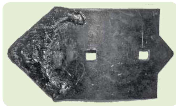
Рис. 2. Упрочнение лапы-наральника плазменной наплавкой в среде сжатого воздуха
