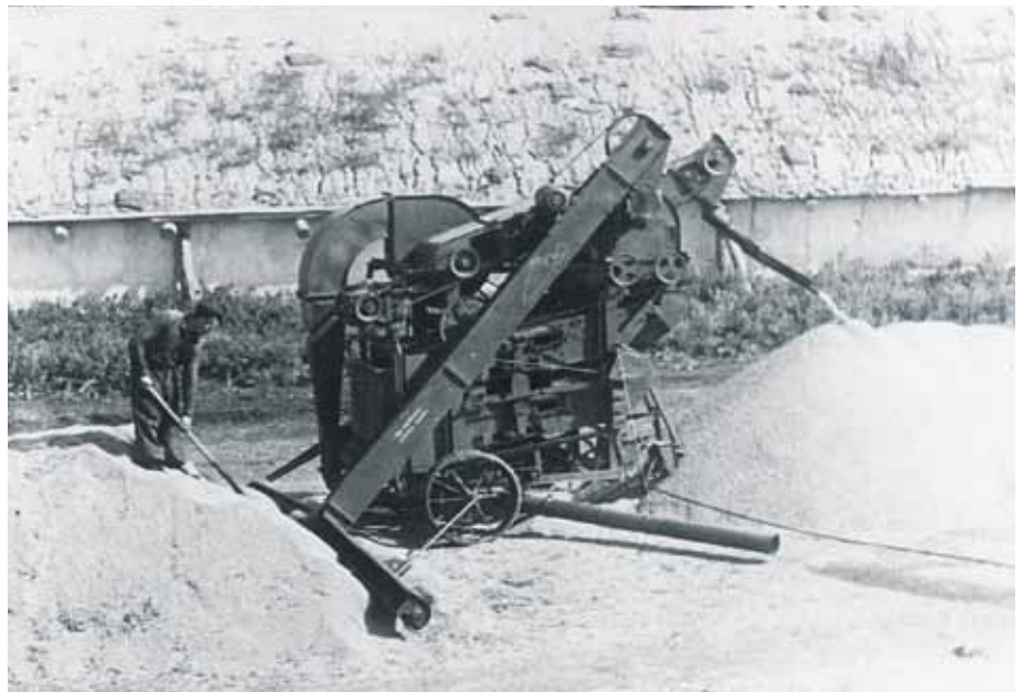
Рис. 1. Очистка комбайнового зерна на току первыми самопередвижными ворохоочистителями ОВП-20
