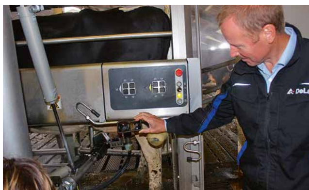
Технология определения сосков InSight с помощью 3D-камеры
