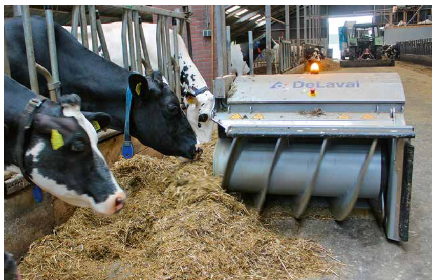
Робот-пушер, перемешивая корм, подвигает его ближе к кормовому столу
