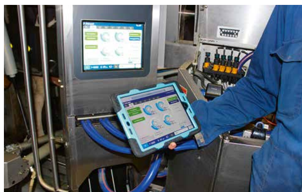
Монитор робота передает информацию о процессе доения на персональный компьютер
