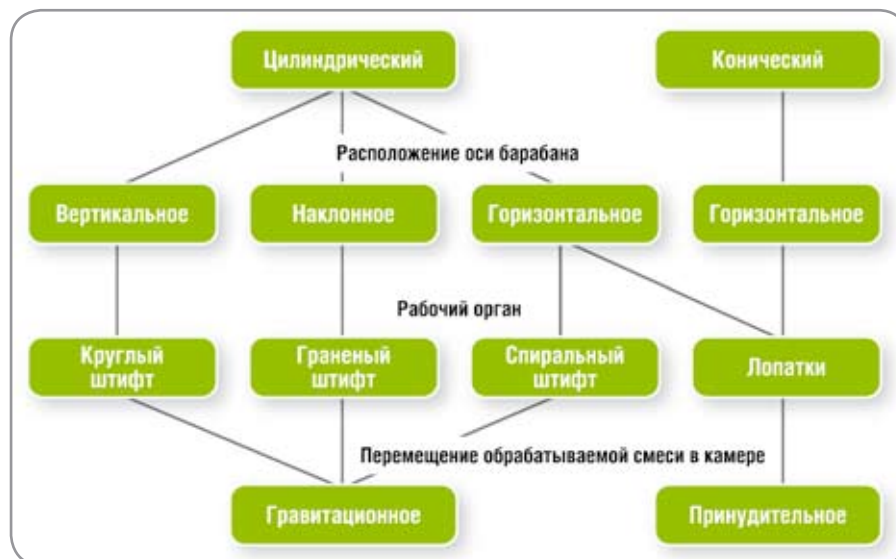
Рисунок 2. Классификация шасталок-терок по конструктивным признакам
