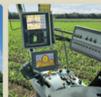
Оснащен терминалом IsoMatch Tellus с программой управления IsoMatch GEOControl
