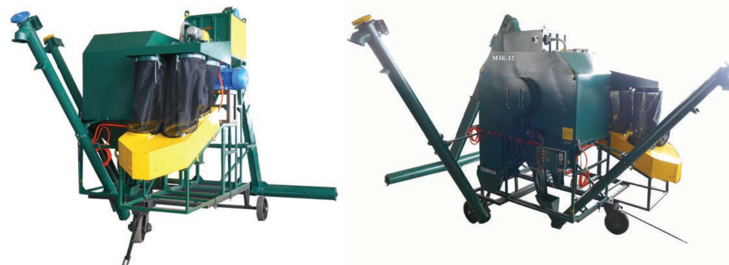
Рисунок 1. Вариант машины МЗК-12С («С» – самопередвижная, в комплект входит: загрузочный скребковый транспортер с боковыми шнеками, два разгрузочных шнековых транспортера, тележка с мотор-редуктором)
