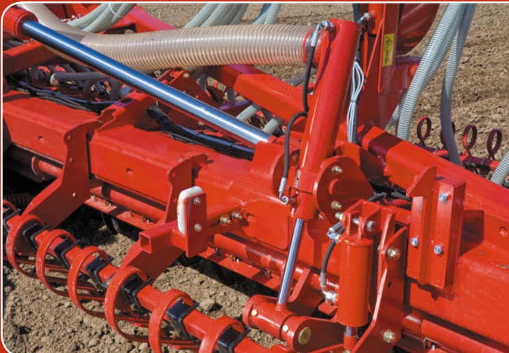
Правым цилиндром регулируется давление сошников, а левым — глубина прикатывающего катка Crossboard
