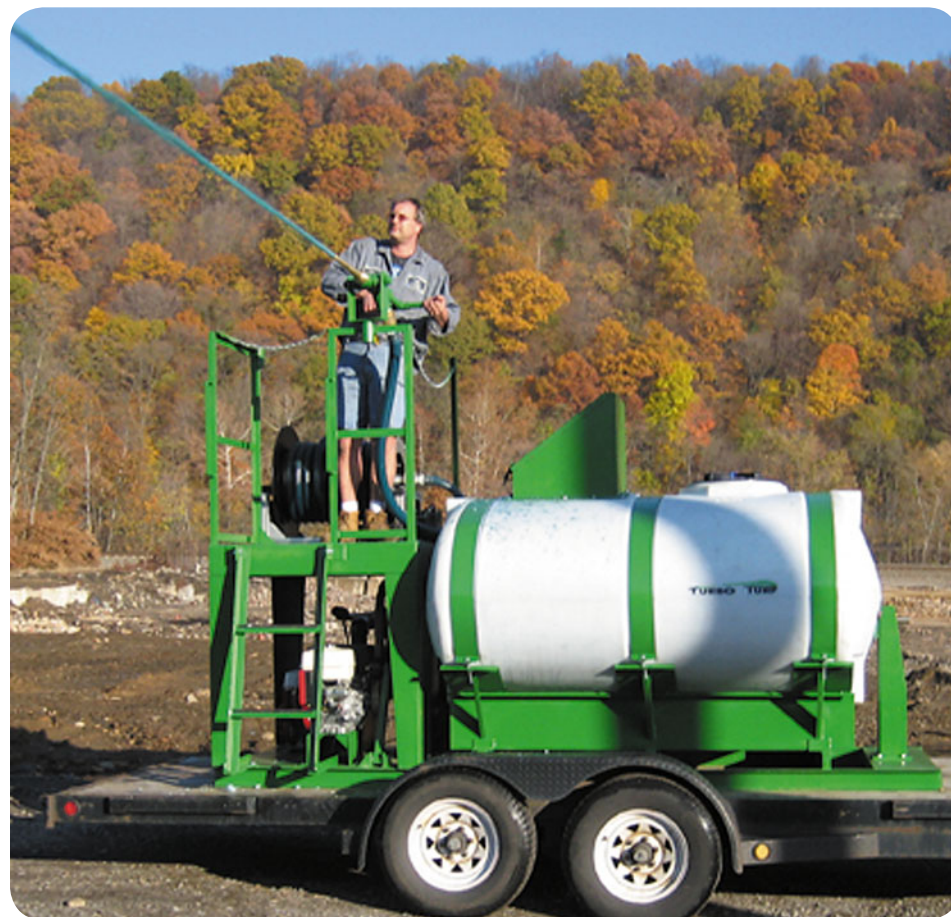
Фото 4. Применение гидропосева для труднодоступных участков.
