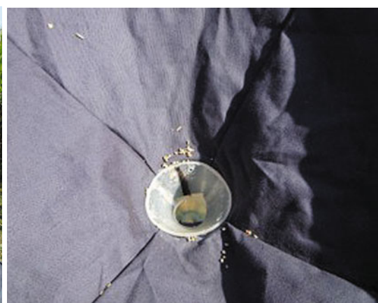
Фото 2. Конуса для определения равномерности аэросева: общий вид (а), вид сверху (б), вид снизу (в).
