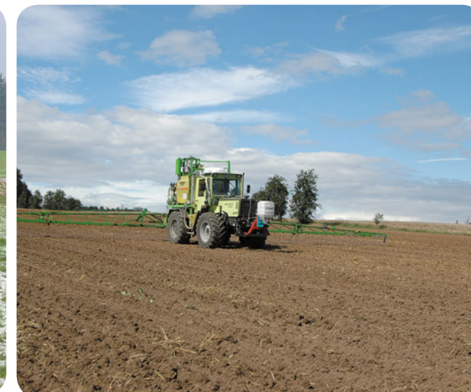
Фото 3. Применение сеялок с 12 В приводом разбросного посева по мерзло-талой почве (а) и при одновременном опрыскивании (б)
