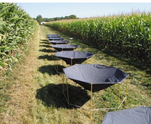
Фото 2. Конуса для определения равномерности аэросева: общий вид (а), вид сверху (б), вид снизу (в).
