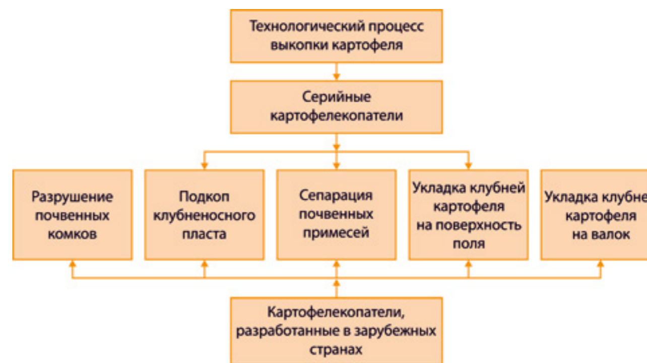
Рисунок 1. Блок-схема технологического процесса работ картофелекопателей
