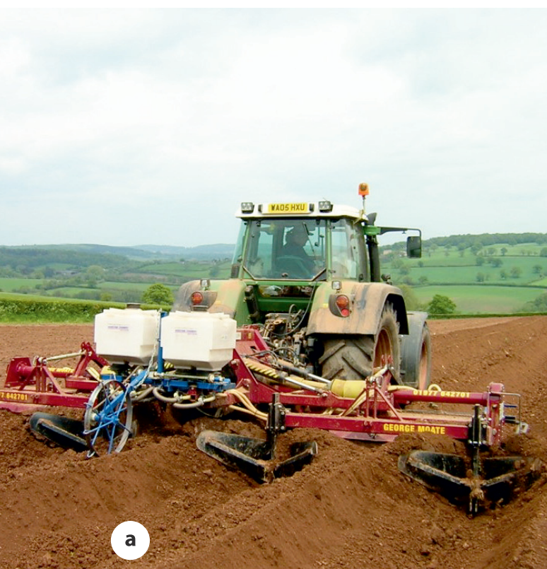
Рис. 1. Внесение гранулированных инсектицидов: а – перед посадкой картофеля; б – в процессе посадки картофеля за один проход (по не вспаханному полю)
