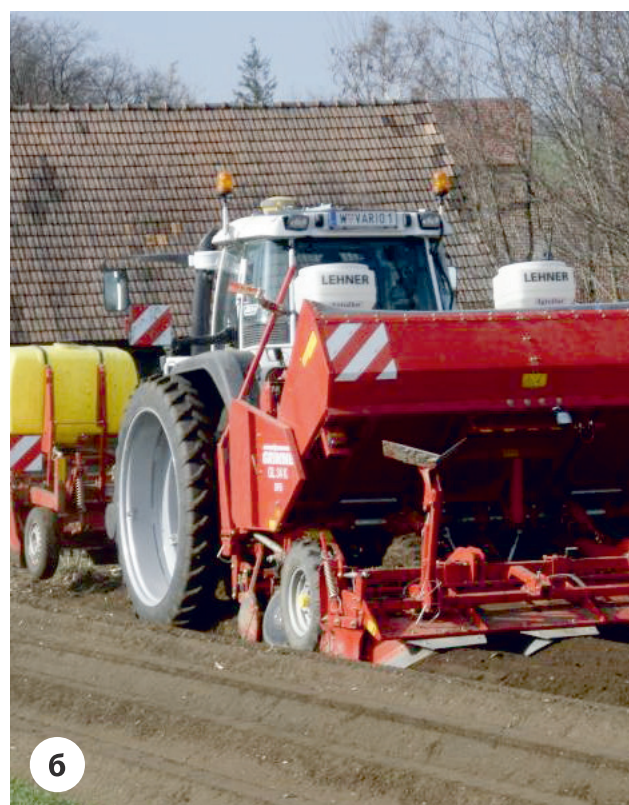
Рис. 1. Внесение гранулированных инсектицидов: а – перед посадкой картофеля; б – в процессе посадки картофеля за один проход (по не вспаханному полю)
