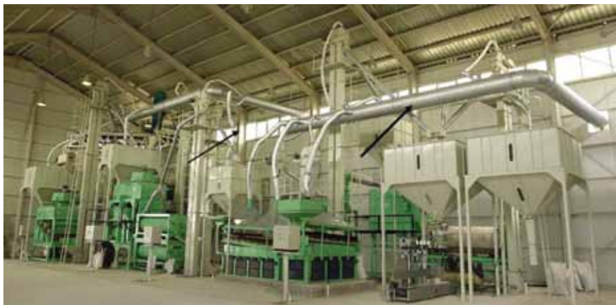
Комплекс машин, расположенных по одноуровневой схеме, для реализации поточных технологий подготовки семян
