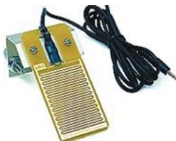
Рис. 3. Датчик влажности листьев
