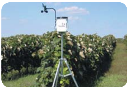
Рис. 1. Метеостанция марки WatchDog
