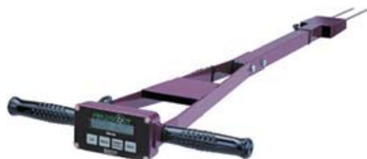
Рис. 8. Электронный влагомер почвы TDR 300
