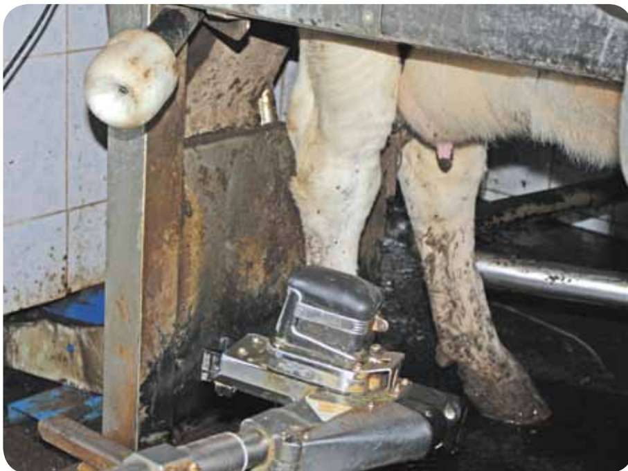
Автоматический процесс доения
