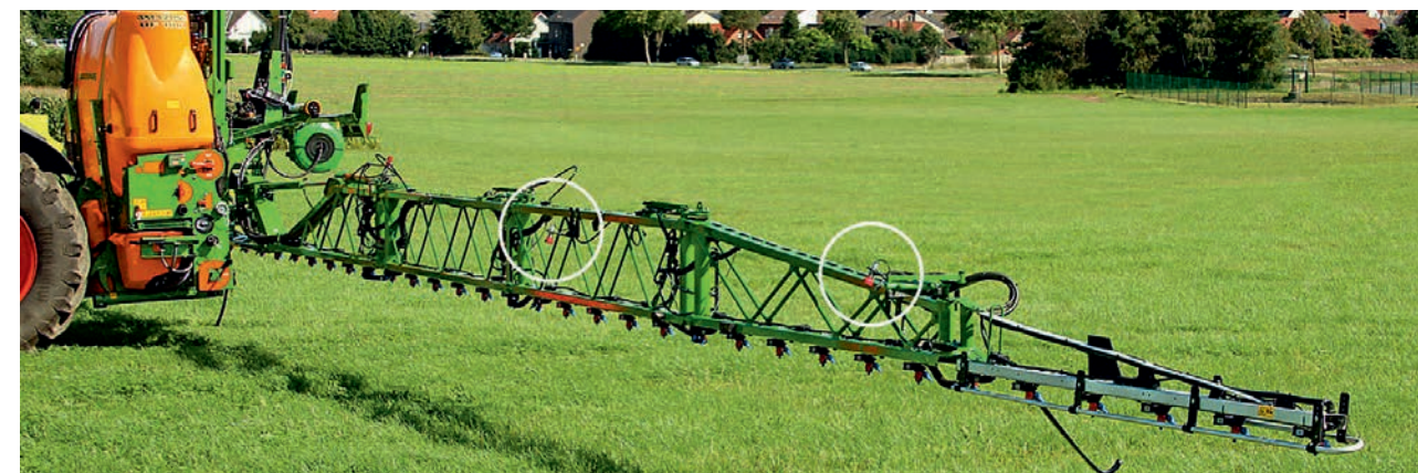
Рисунок 2. Система DistanceControl plus оснащена четырьмя датчиками, по два слева и справа, и обеспечивает улучшенное ведение штанги, особенно на пересеченной местности или неоднородных посевах
