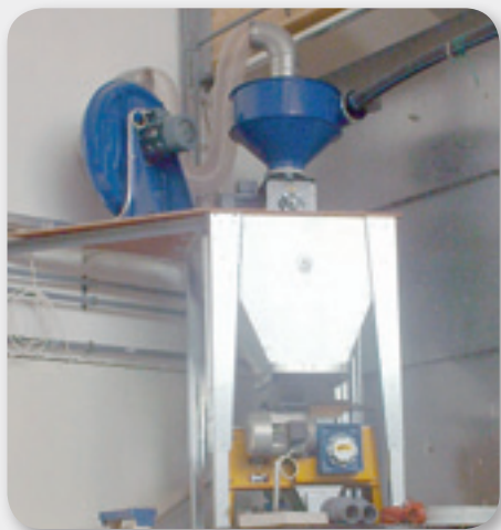
Фото 2. Установка ВМ: а) непосредственно над контейнером; б) в углу здания с выгрузкой через гибкие шнеки
