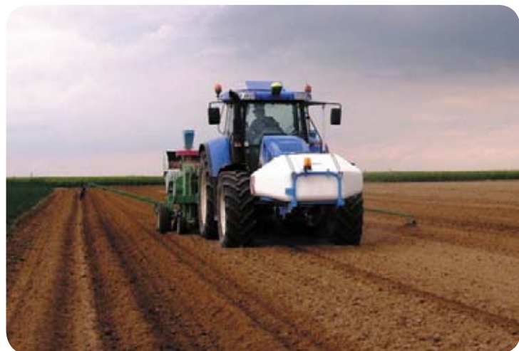
Рис. 1. Внесение жидких инсектицидов в процессе посадки картофеля: а – общий вид; б – основные узлы аппликатора для обработки клубней и корнеобитаемого слоя почвы
