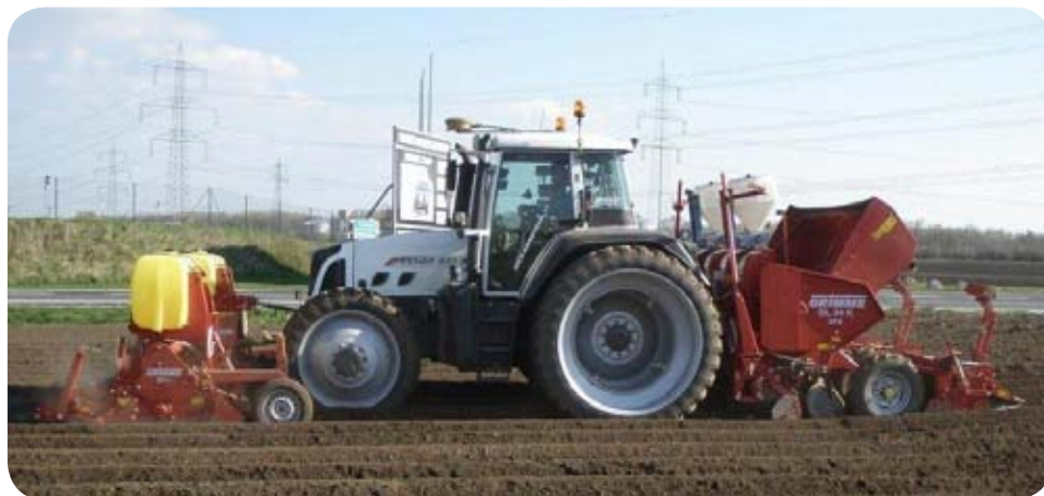
Фото 3. Размещение аппликаторов для жидких и гранулированных пестицидов на машинно-тракторном агрегате при посадке картофеля по необработанному полю
