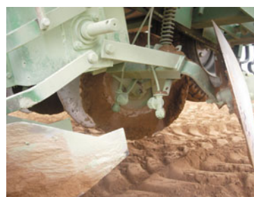
Фото 2. Размещение распылителей и отсекающих в сошниковой зоне сажалки: а – распылители (с отсекающими) перед дисковыми загортачами; б – задний распылитель (с отсекающим на сажалке КСМ-4); в – распылитель с регулируемым наклоном факела; г – общая схема установки распылителей в сошниках (под сходящимся углом)
