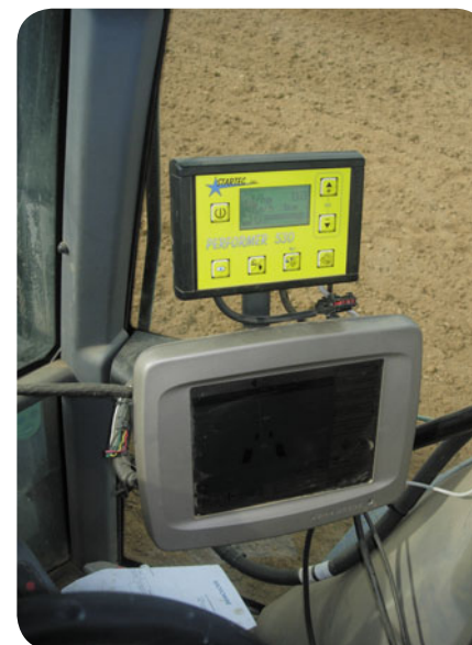
Фото 1. Бортовой компьютер для управления и мониторинга аппликатора для жидкого протравливания на картофелесажалке
