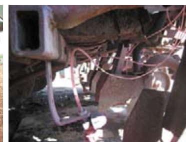
Фото 2. Размещение распылителей и отсекающих в сошниковой зоне сажалки: а – распылители (с отсекающими) перед дисковыми загортачами; б – задний распылитель (с отсекающим на сажалке КСМ-4); в – распылитель с регулируемым наклоном факела; г – общая схема установки распылителей в сошниках (под сходящимся углом)
