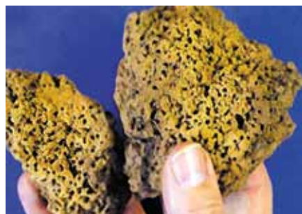
Повреждение утеплителя в птичнике ведет к повышенным теплозатратам
